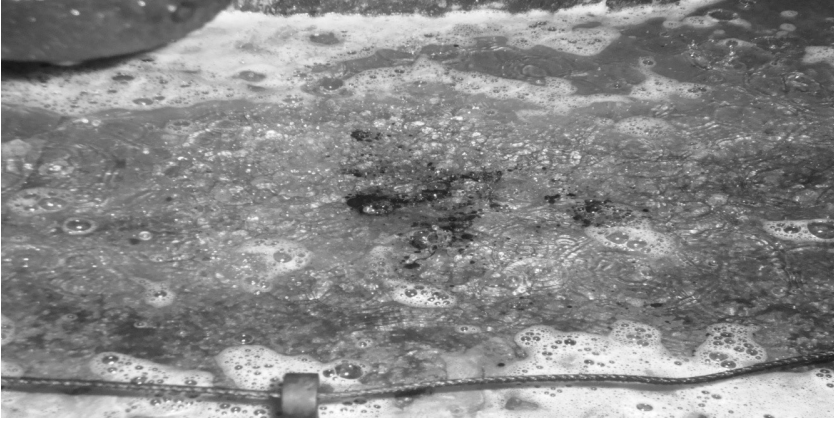
Resim 9: E deterjanı yağ çözünürlüğü testi, siyah lekeler çözünmeyen yağları gösteriyor. Köpük miktarı mevcut deterjana göre azalmış durumda.
