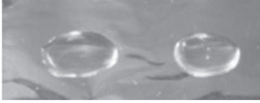
Resim 4: Aynı konsantrasyonlarda iki farklı deterjan örneğinin düz bir yüzeye eşit miktarda damlatılarak yayılma durumunun, yani ıslanma açılarının karşılaştırılması
