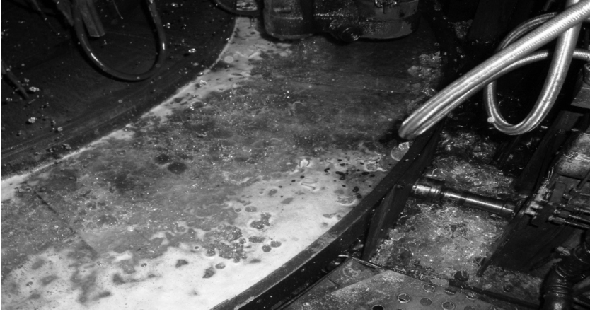
Resim 8: A deterjanı proses sonrası makine tavaından görüntüler. Görüldüğü gibi köpük miktarı azalmış ve siyah lekeler de çözünmeyen yağları gösteriyor.
